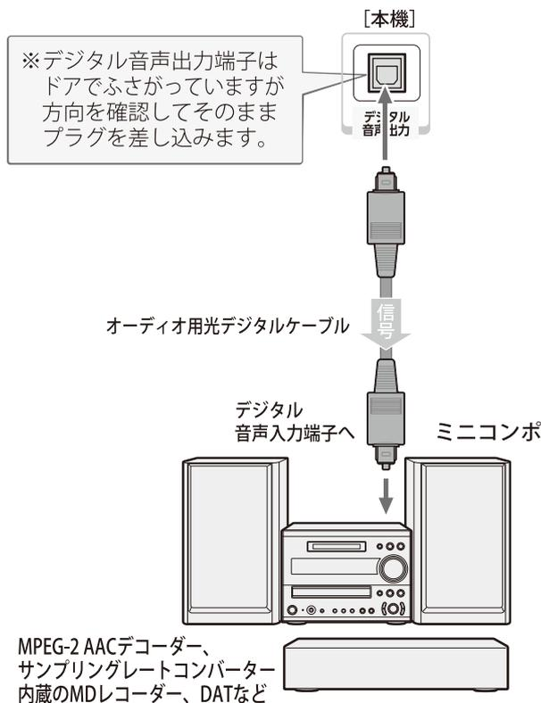
※デジタル音声ケーブルのプラグには2種類の形状があります。接続する機器の端子形状に合ったケーブルをお買い求めください。
