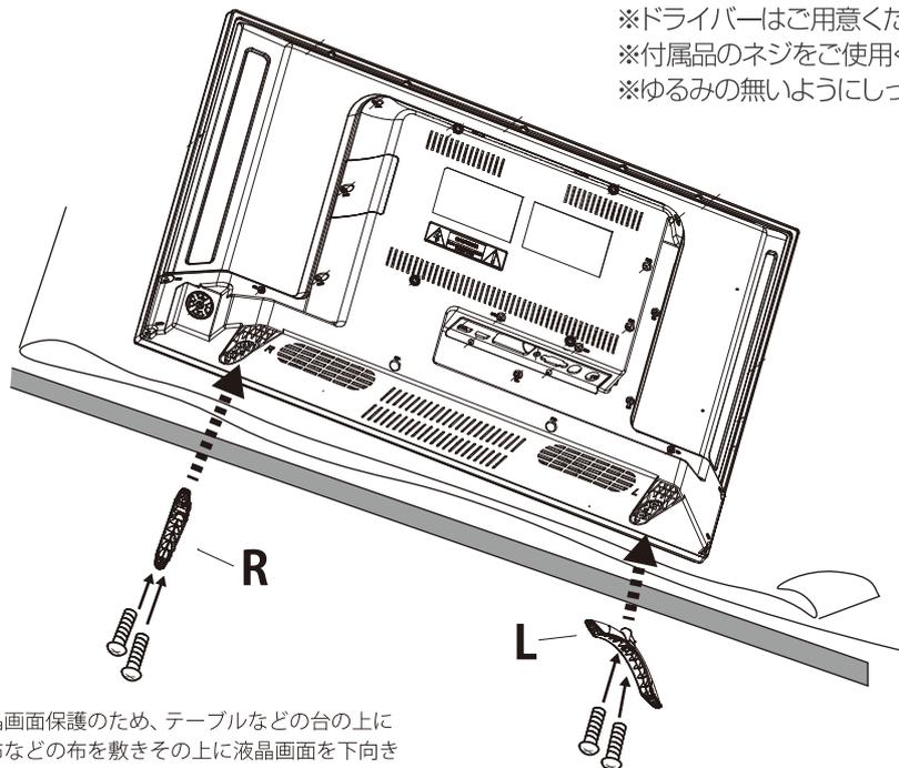
液晶画面保護のため、テーブルなどの台の上に毛布などの布を敷きその上に液晶画面を下向きにして本体を置きます。
