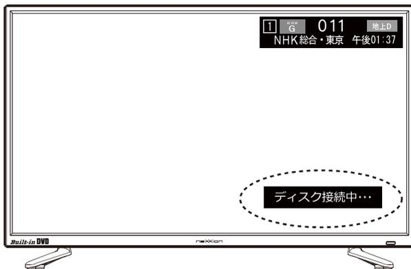
接続してから本機がハードディスクを認識するまで最大1分ほど時間を要する場合があります。ハードディスクの動作中は、本機やハードディスクの電源を切ったり、USBケーブルを抜いたりしないでください。本機やハードディスクの故障の原因となります。また、保存した内容が消去される場合があります。新品のハードディスクの場合、正しく初期化されない場合があります。その場合、パソコンに接続して初期化を行ない、再度、本機に接続して初期化を行なってください。
