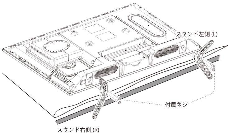
2. スタンド上部の凹部分を本体底面の取り付け部分にはめ込みます。
