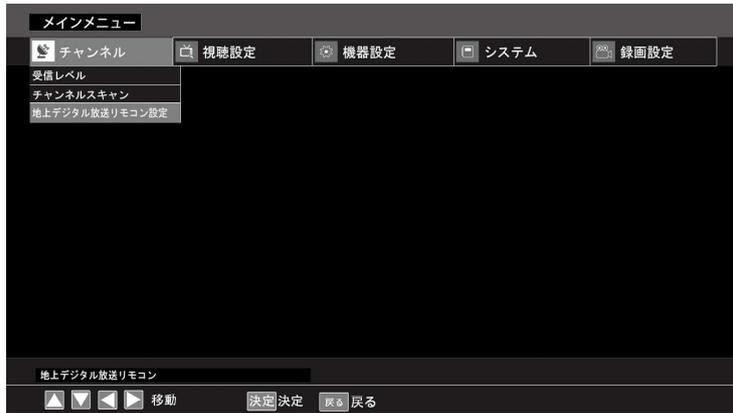
① 現在登録されているチャンネルが一覧で表示されます。矢印ボタン▲・▼で受信するかスキップするかを編集したいチャンネルにカーソルを合わせ、矢印ボタン◀・▶で該当チャンネルの受信とスキップを切り換えることができます。スキップを設定するとチャンネルH/Vボタンでチャンネルを切り換えるときに設定したチャンネルをスキップします。
