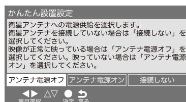
衛星アンテナへの電源供給方法を選び、**(決定)** を押します。
