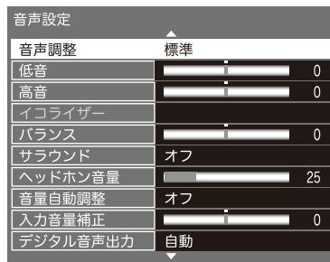
**自動**：サラウンド音声とリニアPCMの信号が自動で識別されます。
