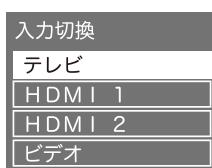
※テレビ視聴中にメニュー設定表示がないときに本体底面のマルチ操作ボタンを短く押すと入力切換ができます。
