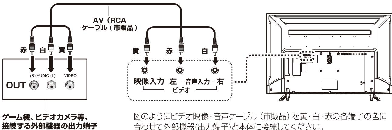
図のようにビデオ映像・音声ケーブル (市販品) を黄・白・赤の各端子の色に合わせて外部機器(出力端子)と本体に接続してください。
