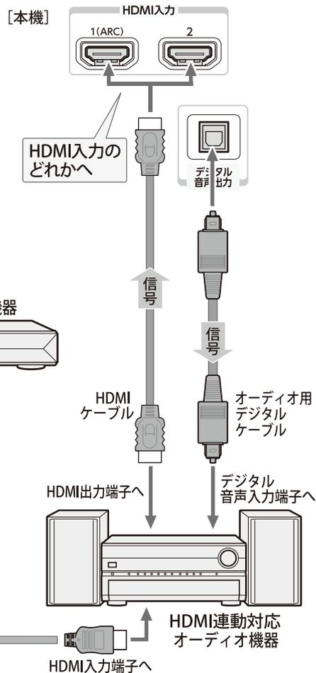
※ARC対応のオーディオ機器を、ARC対応のHDMIケーブルでHDMI入力1 (ARC) 端子に接続する場合は、デジタル音声ケーブルの接続は不要です。
